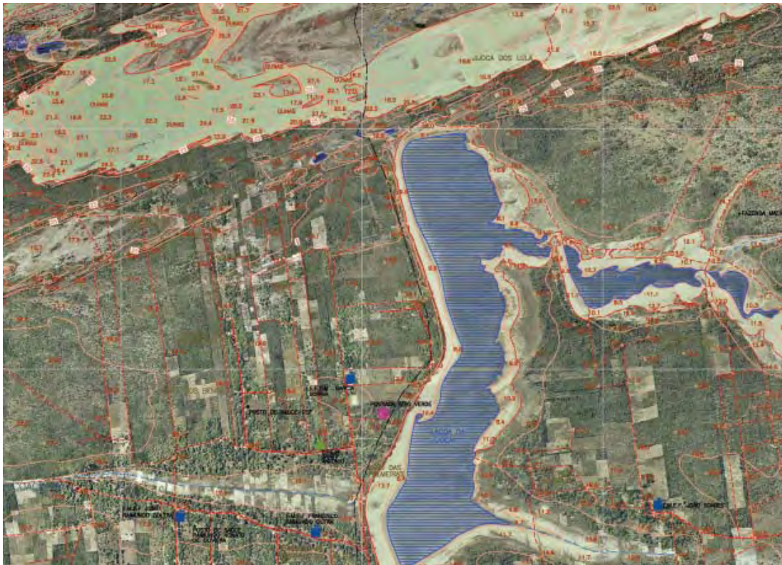
Figura 06 Detalhe de ortofotocarta na escala 1:20.000 apresentando temas restituídos (Escolas, igrejas, rios, lagoas, curvas de nível, etc.).
