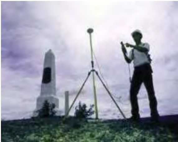
Figura 04 Exemplo de vértice de apoio básico com coleta de coordenadas GPS.
