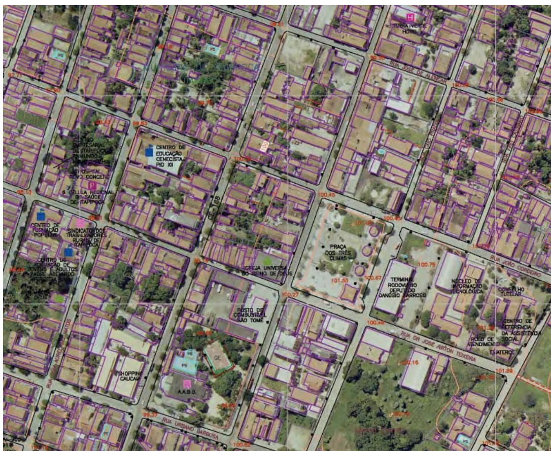
Figura 08 Detalhe de ortofotocarta na escala 1:2.000 apresentando temas restituídos (Lotes, escolas, hospitais, piscinas, hotéis, curvas de nível, etc.).
