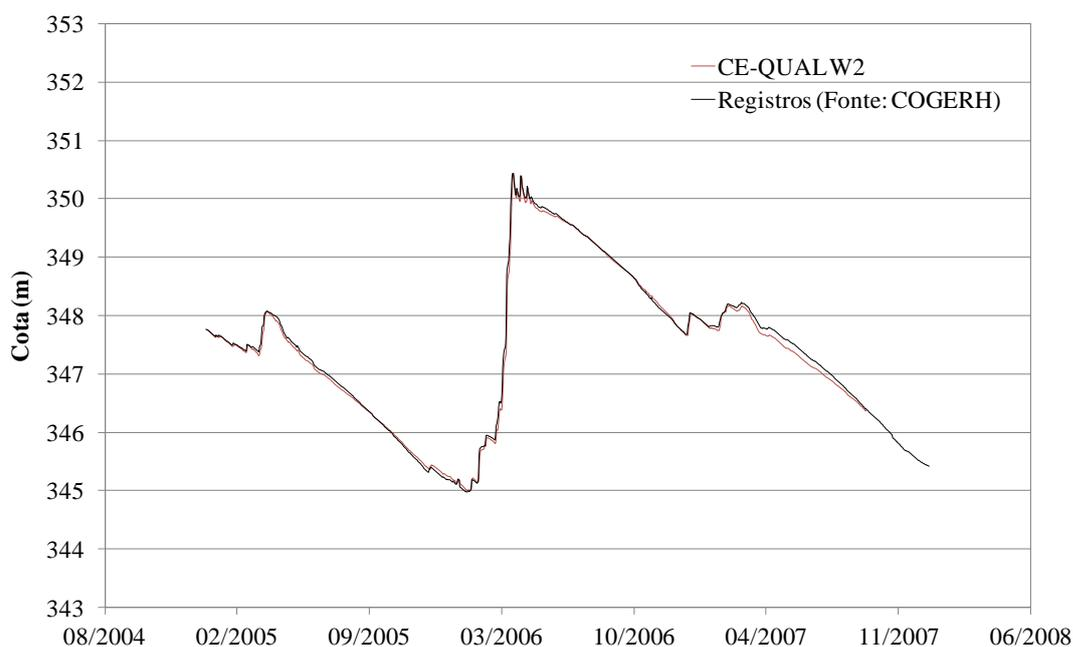
**Figura 4.12 – Comparação das cotas simuladas pelo CE-QUAL-W2 e registradas no açude Olho d'Água.**
