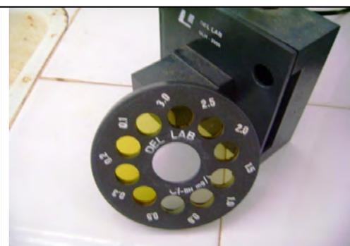
**Foto 16 – Disco de cloro com valor máximo de 3,0mg/l**
